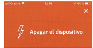
Activando esta función apagará el dispositivo. El dispositivo se encenderá automáticamente encendiendo el vehículo o activando la salida 1 o la salida 2.
