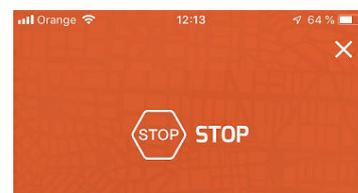
Activando la función de STOP, el vehículo se detendrá de forma segura. Esta operación solo se inicia cuando el vehículo no este en movimiento. Si el vehículo está en movimiento, la operación se iniciará en cuanto el vehículo se detenga.
