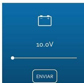
Pulsando el icono, BATERIA veremos un cartel como en la foto el voltaje que se ve esta por defecto configurado desde fábrica, cuando el equipo detecta una bajada de la batería de enviara un mensaje indicando batería baja.
