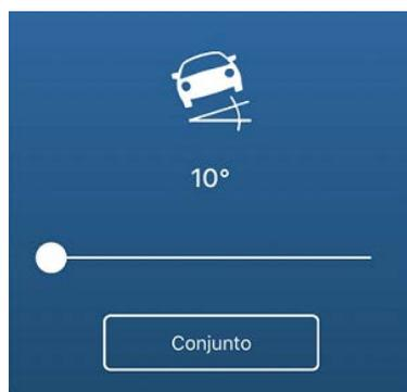
Esta opción es para el control del SENSOR INCLINACION, el dispositivo dispone de un sensor de inclinación que se puede regular, el sensor actúa por grados de elevación a menor grados mas sensibilidad, por defecto esta a 10º, el máximo es de 30º.
